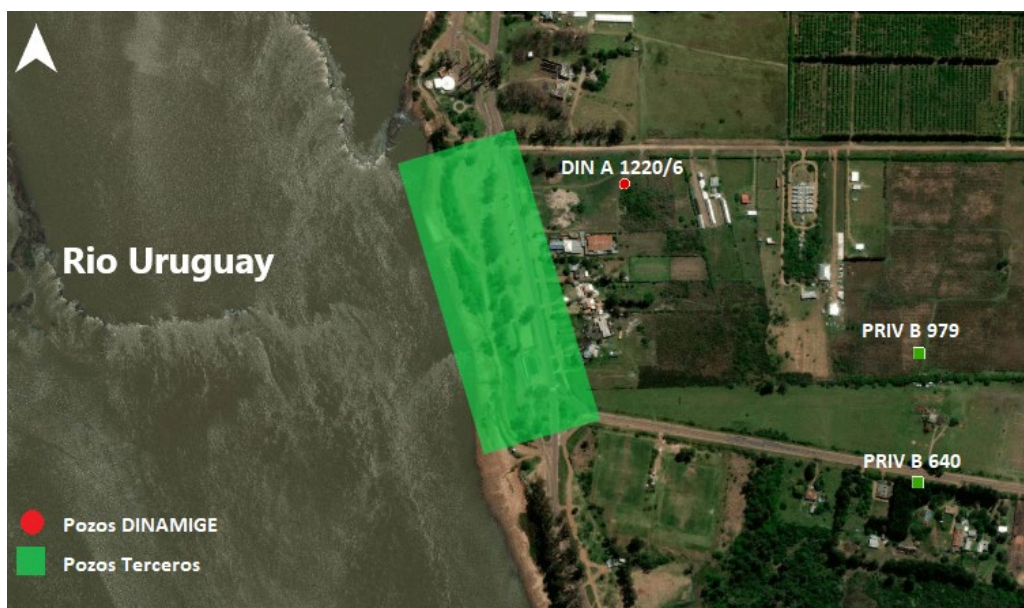
Figura 9 Perforaciones según DINAMIGE y privados para la captación de agua subterránea
