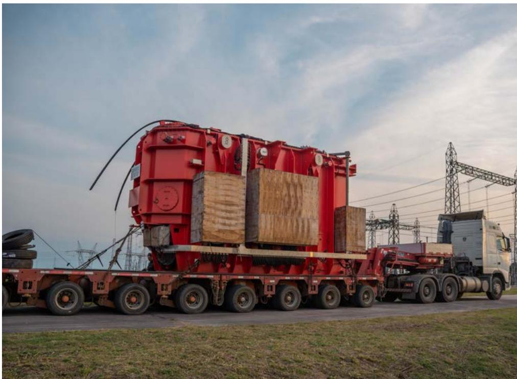
*Transformadores monofásicos de 50 MVA cada uno (150 MVA total) en subestación SJ.*
