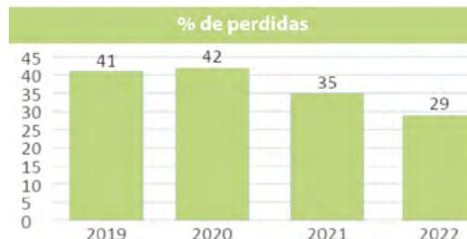
Falta de registro en los consumos (caudalímetros con falla, con rotura, nuevo a instalar), pérdidas que se evidencian por un mayor consumo pero que no son visibles, conexiones clandestinas o consumos mal registrados, hidrantes que no se encuentran totalizados bajo lectura de caudalímetros alteran los números reales e inducen a pérdidas mayores que las que realmente se suceden.
