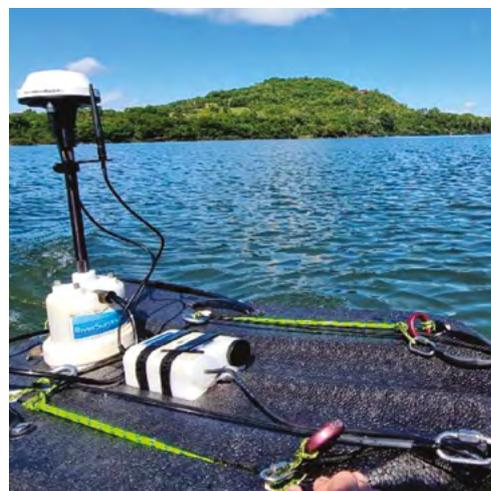
Figura 8: Ejecución de un aforo directo con ADCP, realizado con la colaboración de Prefectura Naval Argentina, en inmediaciones de San Javier (provincia de Misiones).
