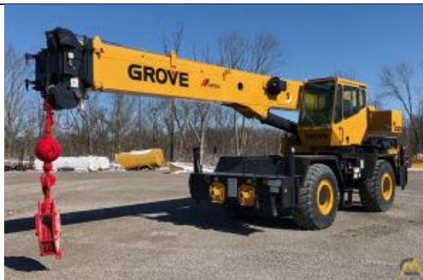
Fotografía 22: Grúa RT 4x4 de 30 Tn
