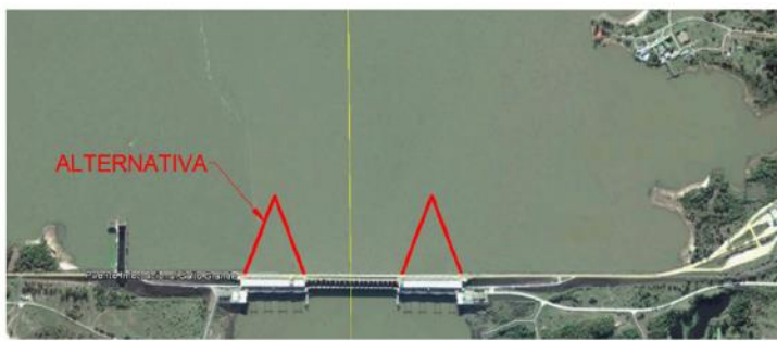
Disposición de barreras flotantes aguas arriba de las centrales
